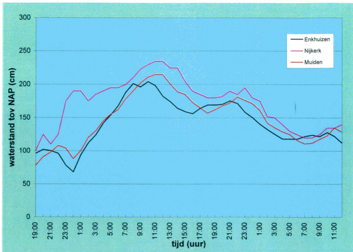
Figuur 2.23 Waterstandsverlopen november 1928 die zijn gebruikt ter bepaling van historische waterstanden langs Markermeerdijken
